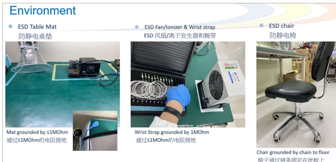
Figure 5 - Elements of ESD safe setup ESD 安全设置的要素
