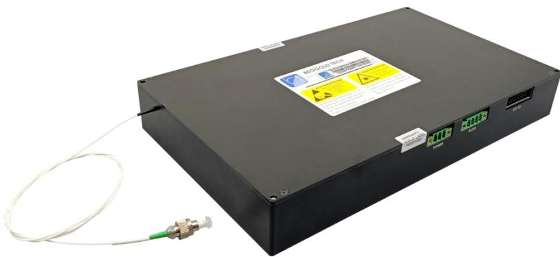
分布式光纤温度传感系统(DTS, Distributed Temperature Sensor)基于拉曼散射原理，利用单根光纤作为传输，对光纤里面的斯托克斯光与反斯托克斯光对温度不同敏感程度来实现温度解析，广泛用于电力、电缆温度监测，石油天然气管线测温检测，地铁、隧道、楼宇等火灾检测。
